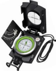
**Boussole avec clinomètre** pour faciliter la pose et l'inclinaison des panneaux solaires. Indique l'inclinaison d'une ligne ou d'un plan par rapport à un plan horizontal et mesure les pentes des terrains.
